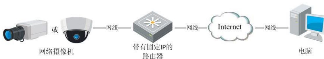
图3.1.1 固定 IP 通过路由器接入摄像机
