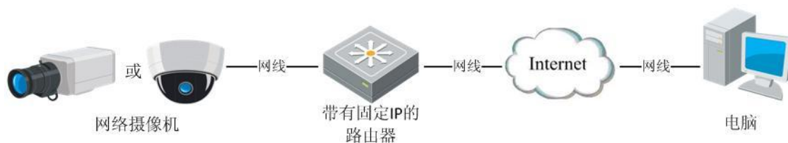
图 3.1.1 固定 IP 通过路由器接入摄像机
