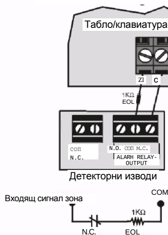
Нормално затворен контакт с EOL, с разпознаване на екран и дефект в кабелизация (UL/ULC)
