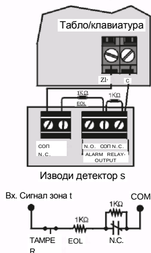
Нормално затворен контакт с EOL, с разпознаване на екран и дефект в кабелизация (UL/ULC)
