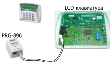
Фиг. 39. Свързване на PRG-896 към LCD-клавиатура
